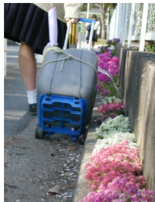
高野先生考案の散水機：ポリ容器と電動ポンプを専用台車に乗せて。
